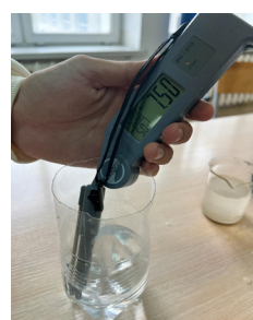
4-сурет – а- лас судың рН-метрі және ә- тазартылған судың рН-метрі
