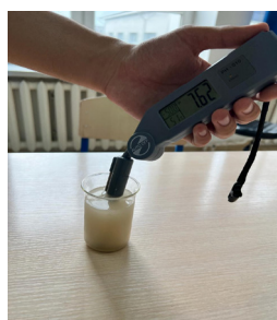
4-сурет – а- лас судың рН-метрі және ә- тазартылған судың рН-метрі
